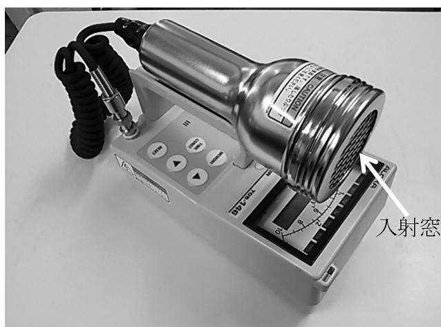
図1：表面汚染用サーベイメータ (GM管式)
