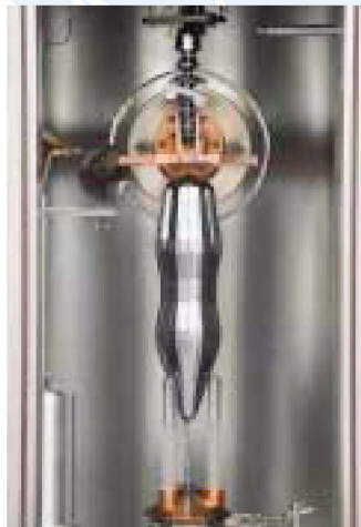
浮遊帯域(FZ)法によって引き上げられた濃縮度99.99%、質量5kgの ^{28}\text{Si} 単結晶
